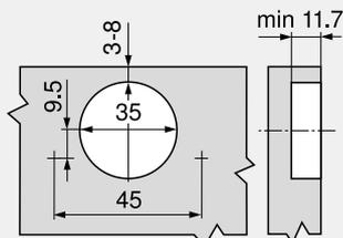
Montaje por encaje a presión
